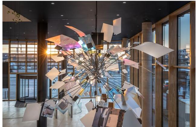
5 Die Medien als auch die OLEDs sind kardanisch, also nach allen Richtungen flexibel ausrichtbar, an den Stabenden befestigt der Skulptur. Die Kabelführung von den OLEDs bis zu den Konvertern verläuft komplett unsichtbar innerhalb der Ausleger und im Rohr. Foto: Steve Troes
